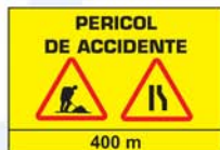
a43 Presemnalizarea unui sector cu circulația alternantă
