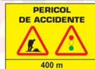
a44 Presemnalizarea unui sector cu circulația alternantă
